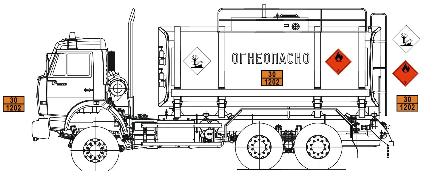
При перевозке опасного груза транспортное средство должно маркироваться знаками опасности, которые устанавливаются с двух сторон, спереди и сзади.
