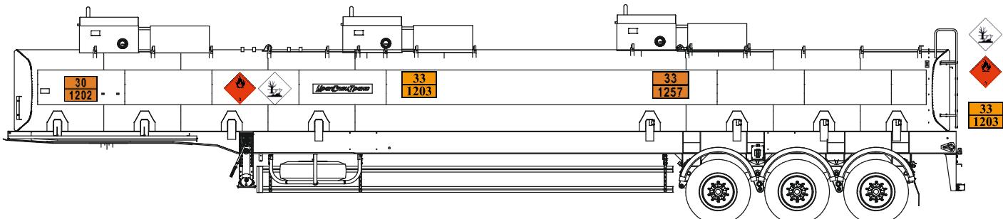
Таблички ООН устанавливаются с двух сторон, спереди и сзади. При перевозке определенных видов грузов сзади допускается установка одной таблички ООН с наиболее опасным веществом, например бензин №1203
